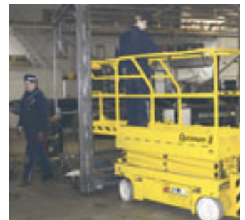
MPN – Metallipaja Niemisen asentajat Jarkko Jokinen ja Juha Pärnäjärvi hitaamassa vetoauton sivu- ja kattoaukeavan kapellikuormatilan runkoa.
